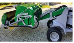
Máquina agrícola autopropulsada con 4 ruedas motrices, hidrostática, con marco de chapa de acero electro-soldado, con eje trasero basculante.
