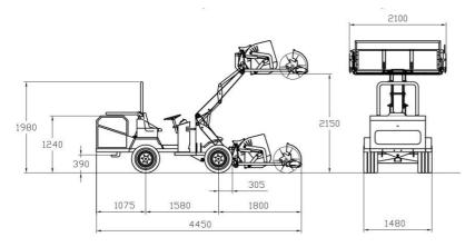
AR 180 - Aparato para la recolección del suelo de aceitunas, almendras, avellanas, nueces, etc., con un ancho de trabajo de 180 cm, con un sistema patentado de nivelación del suelo; Contenedor de contención para el producto de 0,40 mc, sistema de descarga del producto con puerta inferior que se abre hidráulicamente, pies de soporte laterales extraíbles.
